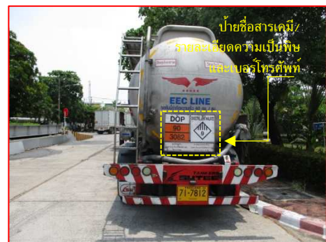
ภาพที่ 2.2-6 ป้ายชื่อสารเคมี/รายละเอียดความเป็นพิษ และเบอร์โทรศัพท์ ที่ตัวรถขนส่งสารเคมี
