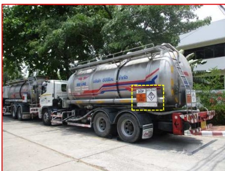
ภาพที่ 2.2-6 ป้ายชื่อสารเคมี/รายละเอียดความเป็นพิษ และเบอร์โทรศัพท์ ที่ตัวรถขนส่งสารเคมี
